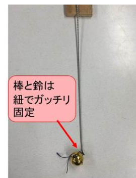
図 2 流速計の完成品
